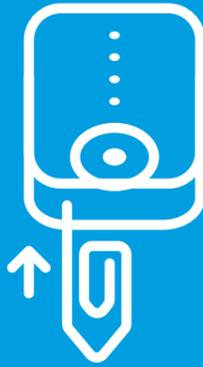
**1** Bitte verwenden Sie eine Büroklammer, schalten Sie das Bluetens ein und stecken Sie die Klammer in das Loch. Wenn Sie die Reset-Taste fühlen können, drücken Sie die Klammer hinein, bis ein Klicken zu hören ist.
